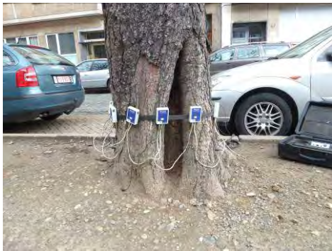
Figuur 10: Opstelling tomograaf test boom 27
