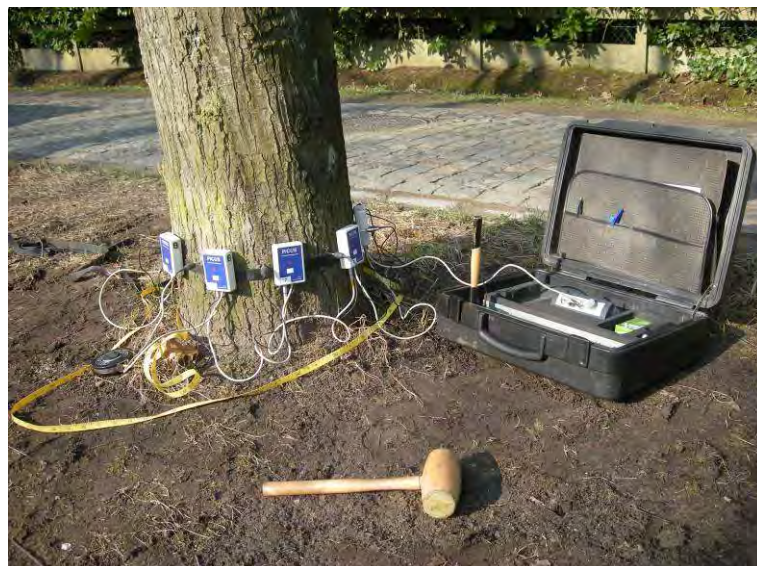
Figuur 3. Opstelling van de tomograaf.
