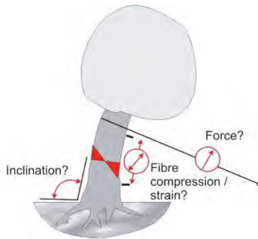
Figuur 4. Opstelling trekproef
