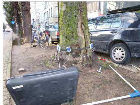
Figuur 10: Opstelling tomograaf test boom 28
